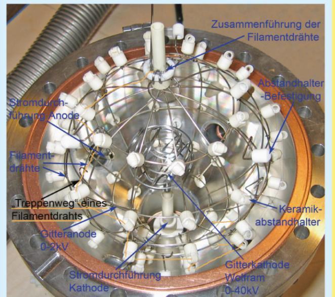
Die Wolfram-Filamentdrähte laufen jeweils parallel zur Gitteranode in einem Abstand von ca. 1cm. In einer aus Filamentdrähten bestehenden Gitterkugel würden, wenn oben und unten mit einer Spannungsquelle angeschlossen ist, nur die vertikalen Dräht zum Glühen gebracht. Um dennoch die gesamte Gitterkathode mit glühenden Filamentdrähten zu umspannen wurden diese treppenförmig durch Abstandhalter geführt.
