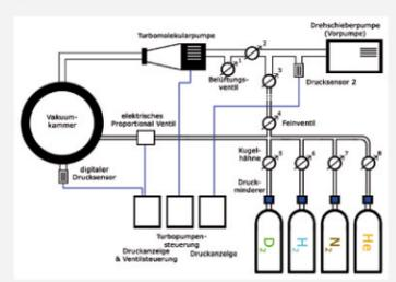
Da das Fusionsplasma nur bei geringen Gasdichten und Drücken entstehen kann, wurde im Versuchsaufbau eine Drehschieberpumpe mit einer Turbomolekularpumpe kombiniert. Durch kontrollierte Gaszufuhr von Helium, Stickstoff, Wasserstoff oder Deuterium können Plasmen mit verschiedenen Gasen erzeugt und verglichen werden. Über ein Proportionalventil kann durch variablen Gasstrom der Druck reguliert und mit einem digitalen Drucksensor gemessen werden.
